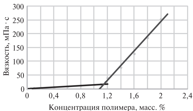
Рис. 1. Зависимость вязкости водного раствора ГЭЦ от ее концентрации в растворе
