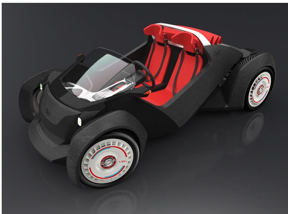
Рисунок 2.17 – Автомобиль Strati, изготовленный с помощью 3D-печати
