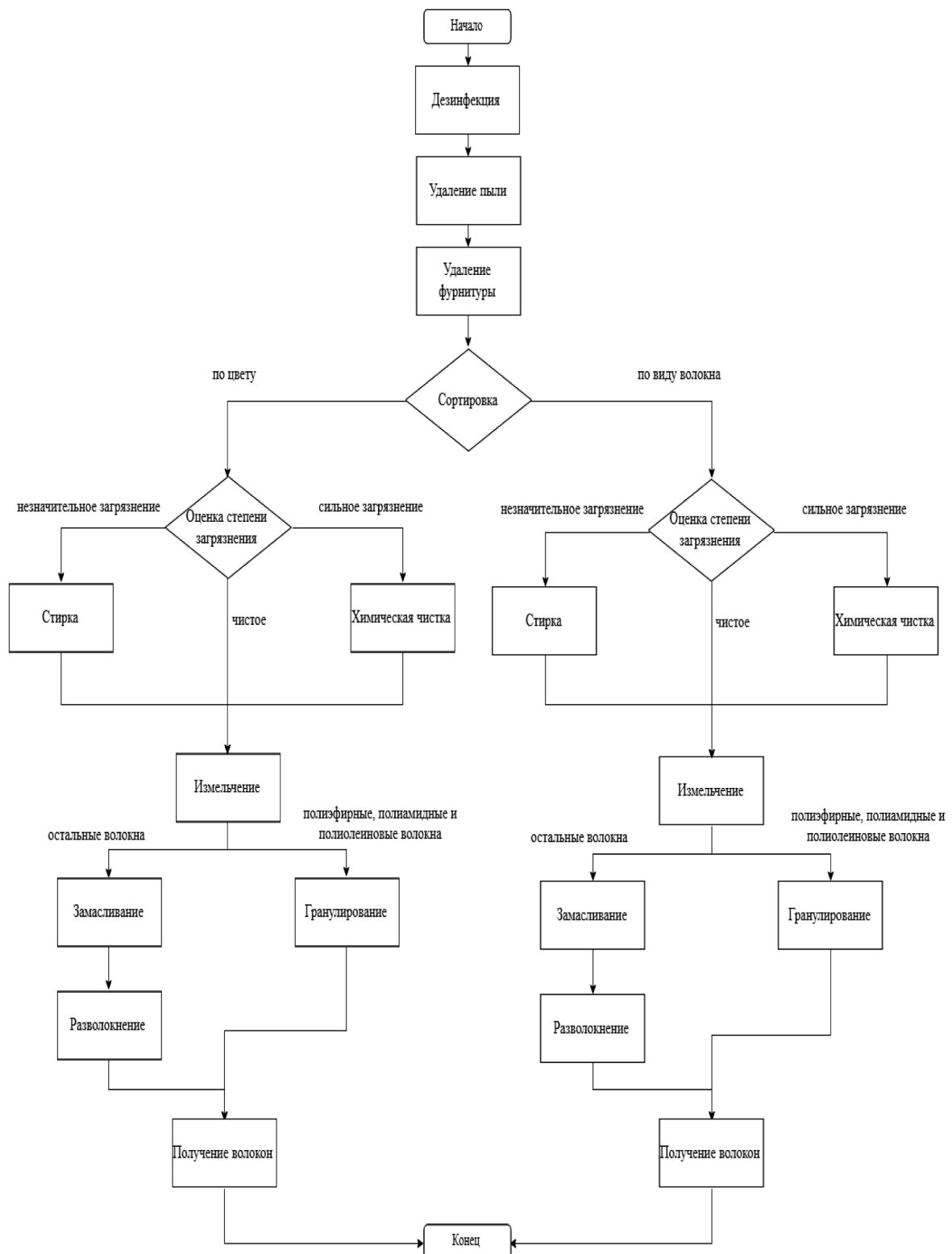
Рисунок 5. Блок-схема процесса переработки текстильных отходов
