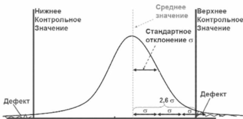
Рис. 1. Стандартное отклонение сигма
