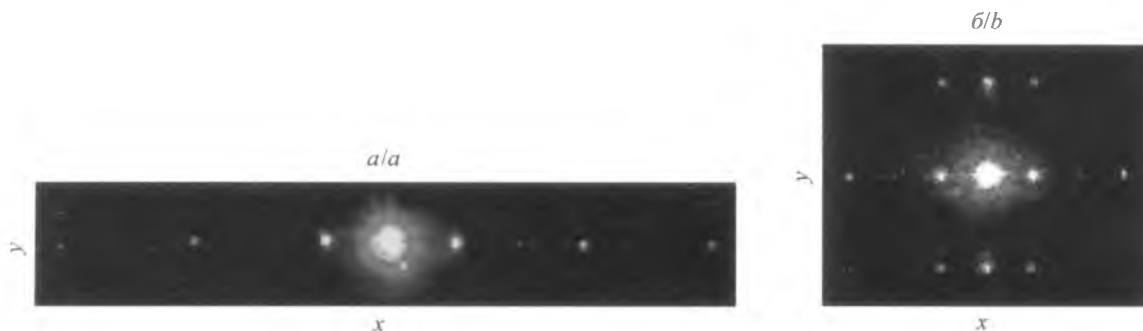
Рис. 5. Дифракционная картина одномерной (а) и двумерной (б) анизотропных фазовых ЖК-решеток
