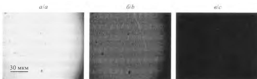
Рис. 3. Поляризационные микрофотографии двумерной дифракционной ЖК-решетки при различных углах между плоскостями пропускания поляризатора и анализатора: a - 0^\circ ; б - 45^\circ ; в - 90^\circ
