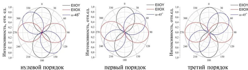
Рис.2. Поляризационные диаграммы дифрагированного света (0-ой, 1-ый, 3-ий порядки) на выходе фазовой ЖК-решетки
