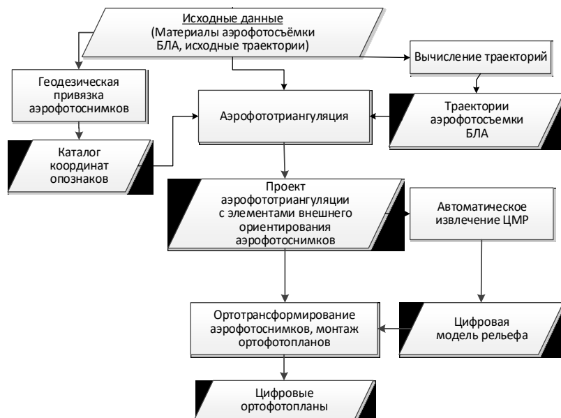
Рис. 1. Общая технологическая схема производства ортофотопланов по материалам аэрофотосъемки БПЛА
