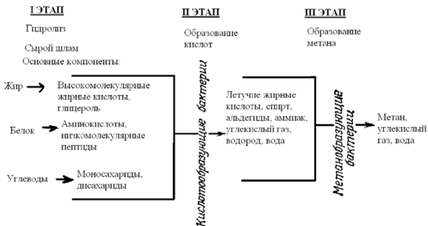
Рис. 2.2. Этапы процесса анаэробного брожения
