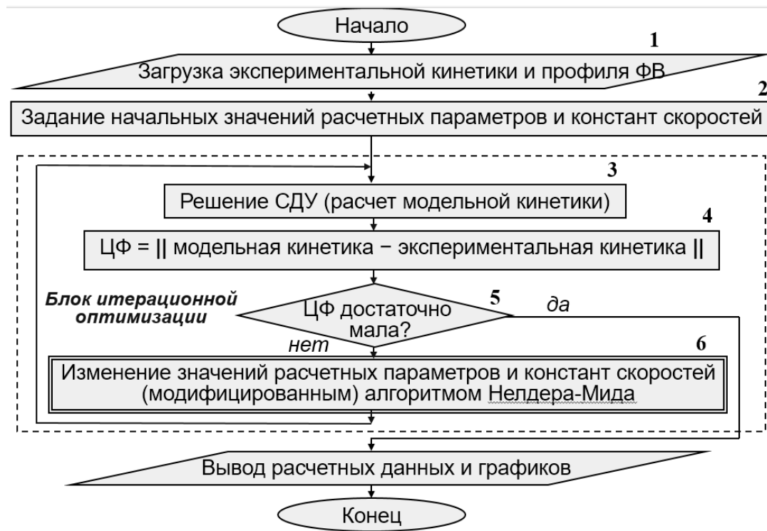
Рис. 1. Графический алгоритм решения обратной фотокинетической задачи методом итерационной оптимизации Нелдера-Мида.
