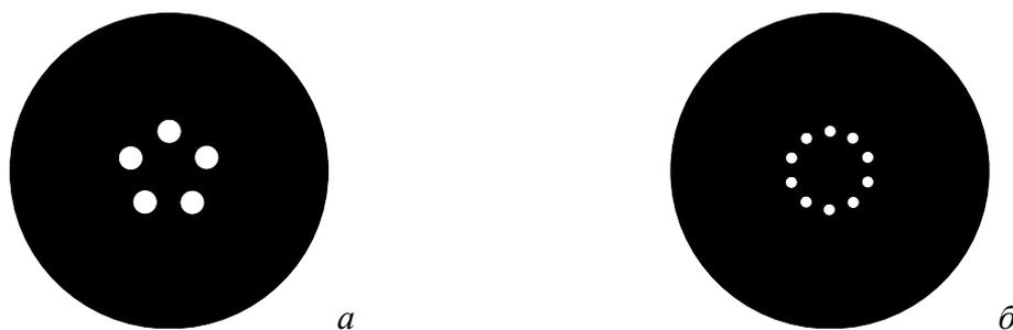
Рис. 1. Конфигурация масок для формирования квазипериодических световых полей с осевой симметрией: а – 5-го порядка, б – 10-го порядка
