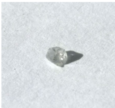
Рис. 2. Монокристаллы алмаза, синтезированные методом НРПТ в системе роста Fe-Al-C
