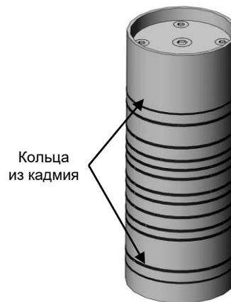
Рис. 1. Облучательное устройство с кольцами из кадмия
