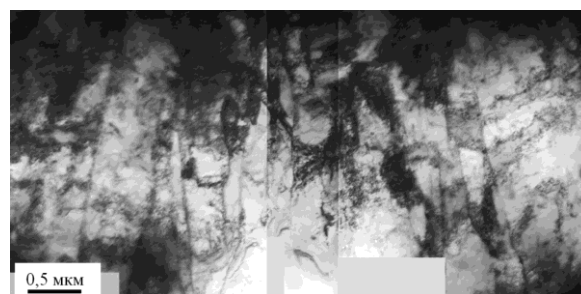
Рис. 1. Изображение мартенситной структуры стали Hardox 450 в исходном состоянии
