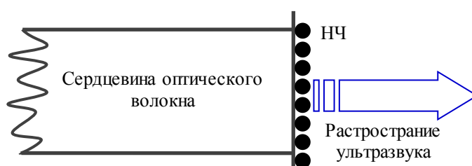
Рис. 1. Структура фотоакустического преобразователя с металлическими наночастицами на торце оптического волокна в окружающей среде
