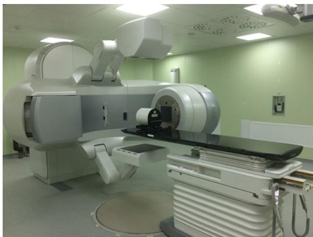
Рисунок 1 – Фантом IsoCal установлен для проведения теста MPC медицинско линейного ускорителя True Beam STx
