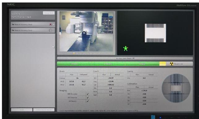
Рисунок 2 – Интерфейс приложения Machine Performance Check
