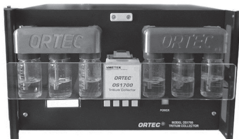
Рисунок 2 – Пробоотборное устройство коллектор трития «OS1700»
