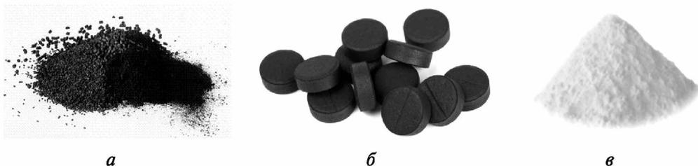
Рис. 2. Композиционные реагенты для очистки природных и сточных вод: коагулянт + флокулянт + уголь (гранулят) (а); угольный коагулянт (таблетки) (б); коагулянт + флокулянт + регулятор pH (порошок) (в)
