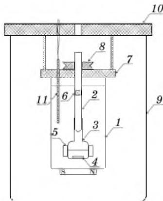
Схема изопериболического реакционного калориметра, использованного в данной работе, представлена на рис. 1. Калориметр может быть использован для определения тепловых эффектов от 6 до 1000 Дж. Инструментальная погрешность определения подъема температуры не превышает  $\pm 0,2$  мК. По окончании опыта реакционную смесь охлаждали до 290 К и разбавляли водой. Избыток *mim* титровали 0,100 М  $\text{HNO}_3$ .
