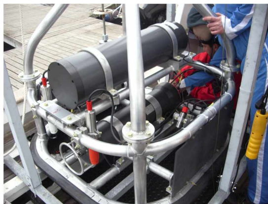
Рис. 2. Спектрометр, размещенный в составе глубоководной исследовательской станции MEDUSA
