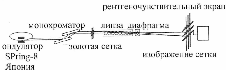
Рис. 11. Схема экспериментальной установки для получения изображения золотой сетки
