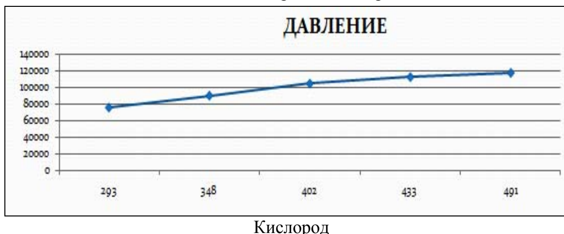
Рис. 2. Зависимость давления от температуры для двухатомного газа
