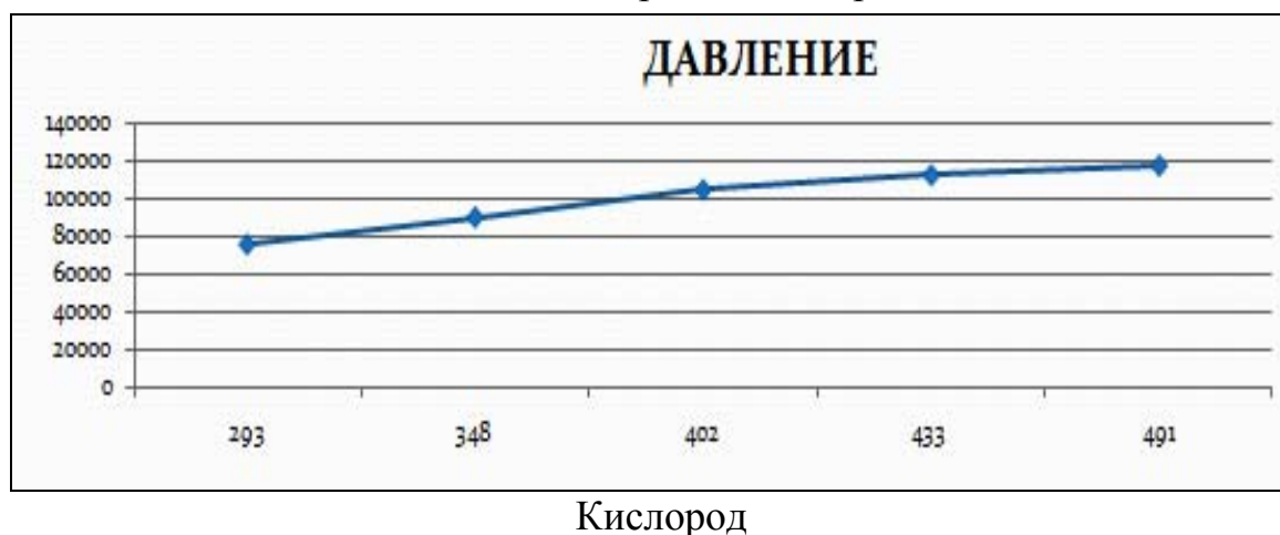
Рис.2. Зависимость давления от температуры для двухатомного газа
