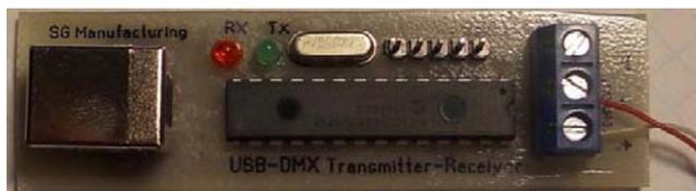
Рис. 3.– Внешний вид преобразователя USB-DMX
