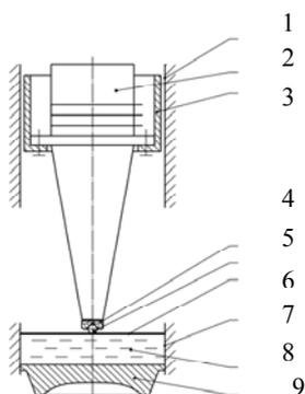
Рис. 1 – Виброударный инструмент с ультразвуковым возбуждением.
