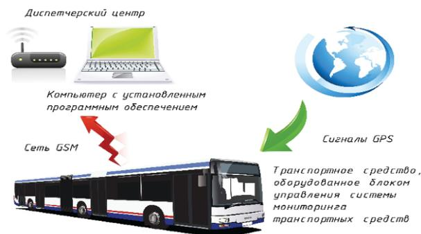
Рис. 1 – Модель работы системы мониторинга транспортных средств
