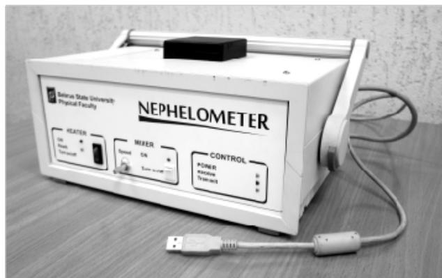
Рис.1 – Лазерный нефелометрический анализатор (общий вид)
