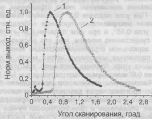
Рис.3. Угловые распределения протонов с энергией 380 кэВ рассеянных поверхностью кремния при угле падения 0,3^\circ (1) и 0,5^\circ (2)
