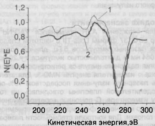
Рис. 3. KLL-спектры углерода пленок, осажденных при различной плотности мощности лазерного излучения: 1 – 2,6 \cdot 10^8 Вт/см 2 ; 2 – 4,9 \cdot 10^8 Вт/см 2 .
