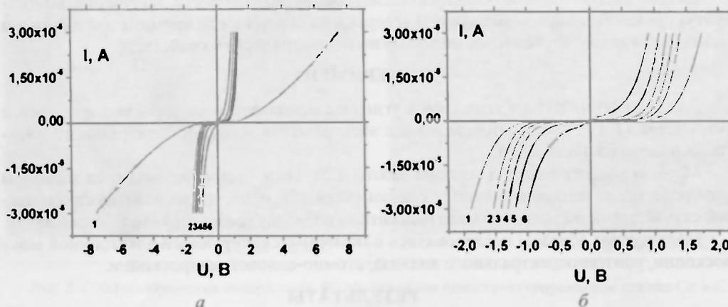
Рис. 4. Вольт-амперные характеристики структур Ni/SiO<sub>2</sub>/Si без магнитного поля (а) и в магнитном поле 8 Тл (б) при температурах 25 К (1), 50 К (2), 100 К (3), 150 К (4), 200 К (5), 250 К (6), 310 К (7)
