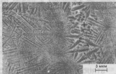
Рис. 3. Изображение поверхности системы \text{Ni/Si}(100) , обработанной импульсом водородной плазмы
