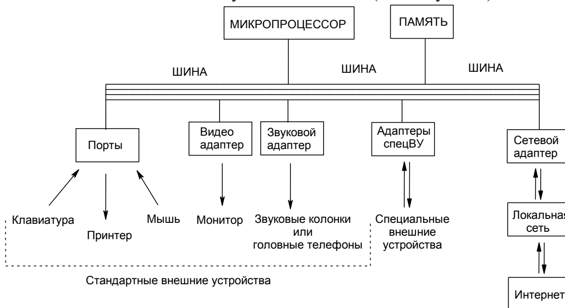
Рисунок 1 – Структурная схема ПЭВМ.
