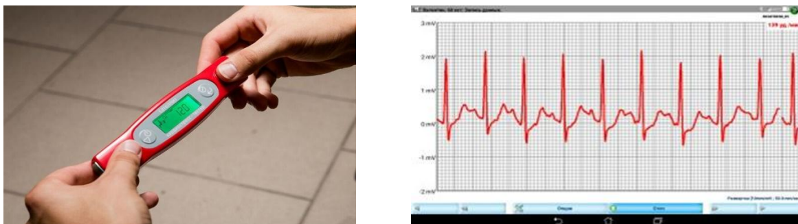
Рис. 2. Съем ЭКГ в I стандартном отведении и ее отображение на смартфоне
