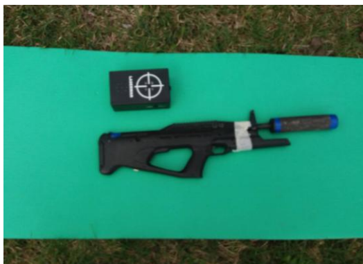
Рис. 1. Спортивная винтовка с лазерным излучателем видимого спектра и интерактивное табло (мишень)
