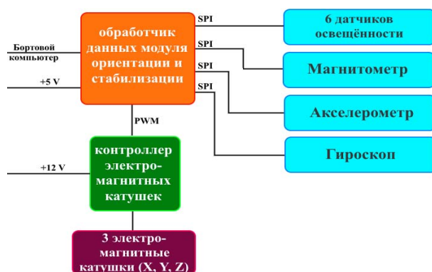
Рис. 1. Структурная схема модуля ориентации и стабилизации МКА
