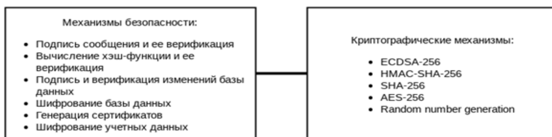
Рис. 1. Архитектура модуля системы защиты информации
