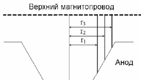
Рисунок 2. – Схема измерений магнитного поля торцевого холловского источника ионов на расстояниях r_1 , r_2 и r_3 от центральной оси
