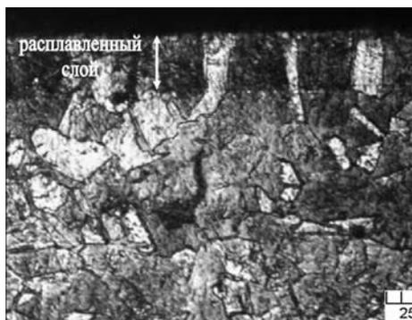
Рисунок 2.6 – Микроструктура поперечного шлифа образца меди М1 (степень деформации 35%), обработанного КПП с плотностью поглощенной энергии 14 Дж/см<sup>2</sup>
