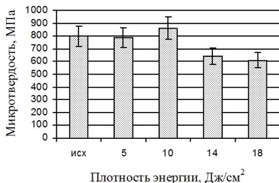
Рисунок 2.7 – Средние значения микротвердости на поверхности исходного образца и поверхности, обработанной плазмой с плотностью энергии 5–18 Дж/см<sup>2</sup>, при нагрузке 1 Н
