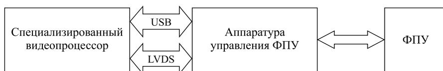
Рис. 1. Подключение составных частей ЭО широкозахватного оптоэлектронного сканера
