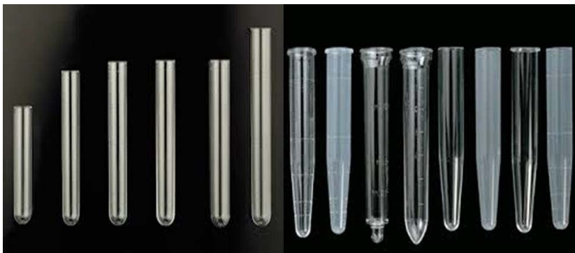
Рисунок 1.1 – Виды пробирок для лабораторных исследований: слева – химические пробирки, справа – центрифужные пробирки (конические)
