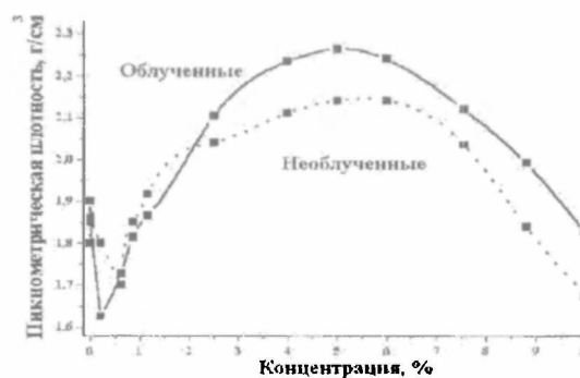
Рис. 7. Зависимость пикнометрической плотности смешанных кристаллов от концентрации \text{CdCl}_2 в системе \text{KCl}-\text{CdCl}_2-\text{H}_2\text{O} .
