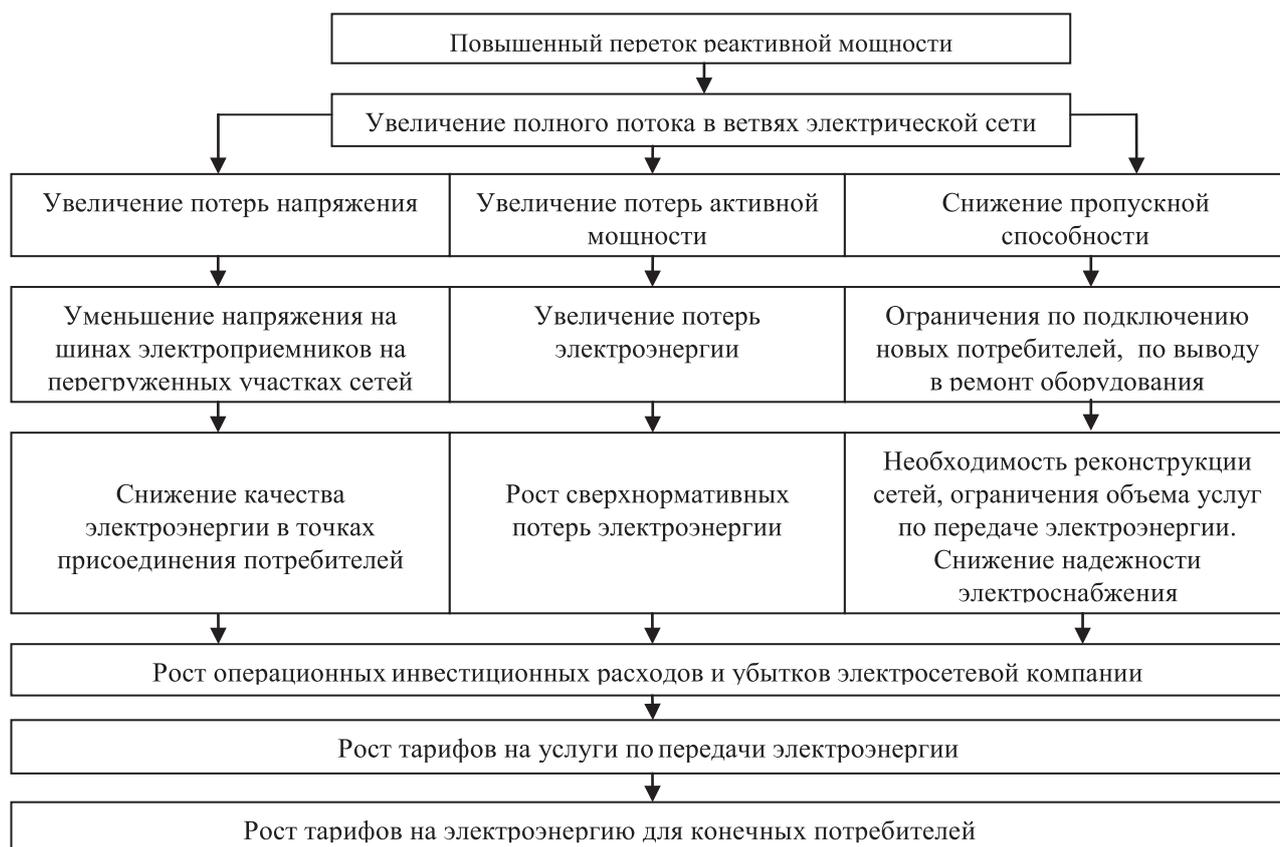
Рисунок – Последствия повышения транспортировки реактивной мощности
