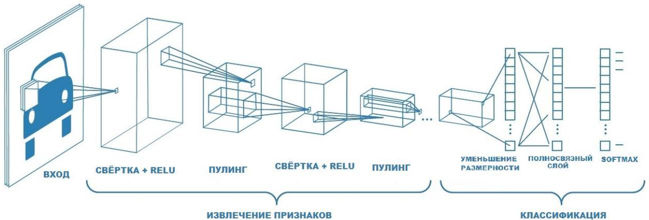
Рисунок 3.6 – Архитектурная схема свёрточной нейронной сети для классификации изображений
