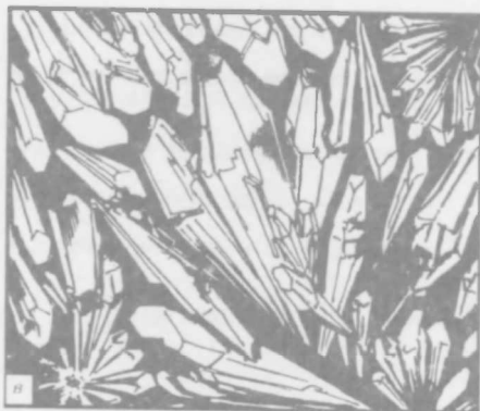
Структурные разновидности гипса Бриневско-го месторождения: а – пластинчатая (розетки в ангидрите), ув. 4х; б – волокнистая, нат. вел.; в – шестовато-столбчатая, ув. 20х
