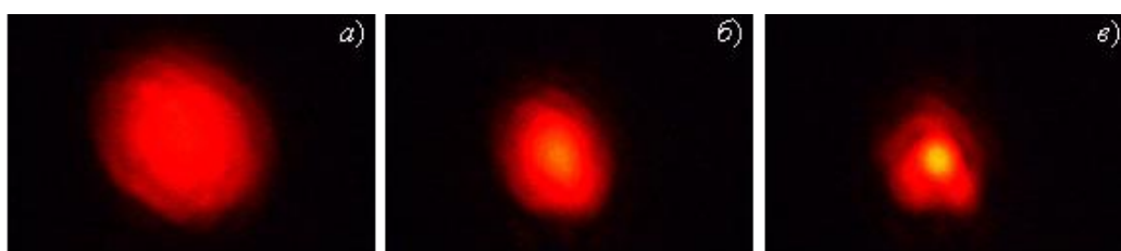
Рисунок 4. – Распределение интенсивности пробного пучка на выходе из нелинейной среды при интенсивности пучка накачки на входе в кювету I : а) 0 МВт/см 2 , б) 40 МВт/см 2 , в) 70 МВт/см 2
