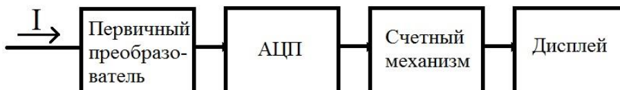
Рис. 5.2. Структурная схема цифрового измерительного прибора
