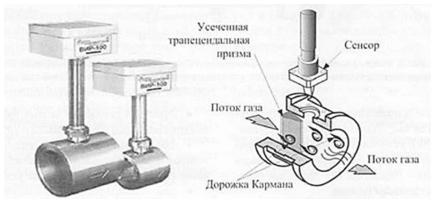
Рис. 3.36. Вихревые счетчики типа ВИР и принципиальная схема работы
