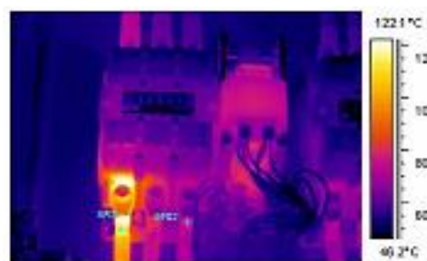
Рис. 2.7. ИК-изображение контактов в системе электрооборудования
