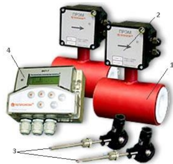
Рис. 3.29. Части теплосчетчика с ультразвуковым водосчетчиком: 1 – корпус ультразвукового водосчетчика с фланцами для присоединения к трубопроводам сети теплоснабжения; 2 – устройство генерации ультразвука и регистрации расхода жидкости; 3 – термодатчики сопротивления; 4 – вычислитель с автономным электропитанием от батарей
