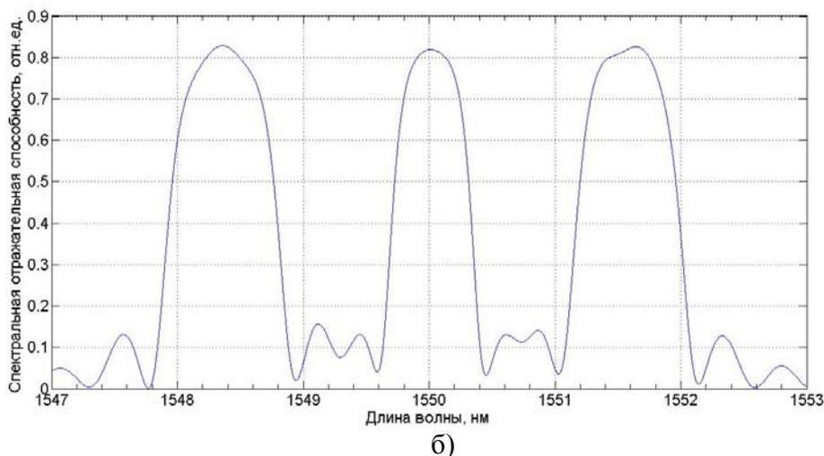
Рис. 1. Спектральная отражательная способность для 3-х ВБР для одномодового ВС при  $\Delta\lambda=1.6$  нм (б)
