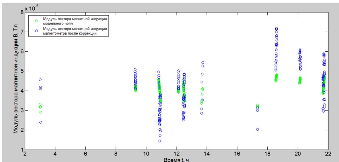
Рис. 2. Результаты коррекции данных модуля вектора магнитной индукции магнитометра по отношению к модельному магнитному полю в расчетных точках орбиты данных телеметрии СМКА Grifex
