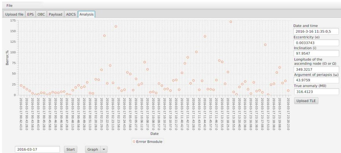
Рис.4. Вектор ошибок модуля вектора магнитной индукции (модели и магнитометра)
