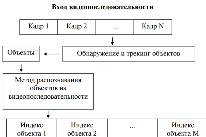
Рис. 2. Схема процесса распознавания объектов на видеопоследовательности
