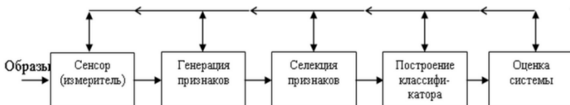
Рис. 1. Основные элементы системы распознавания объектов
