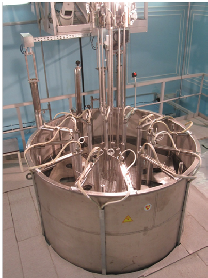
Рис. 1. Критическая сборка с водяным замедлителем
