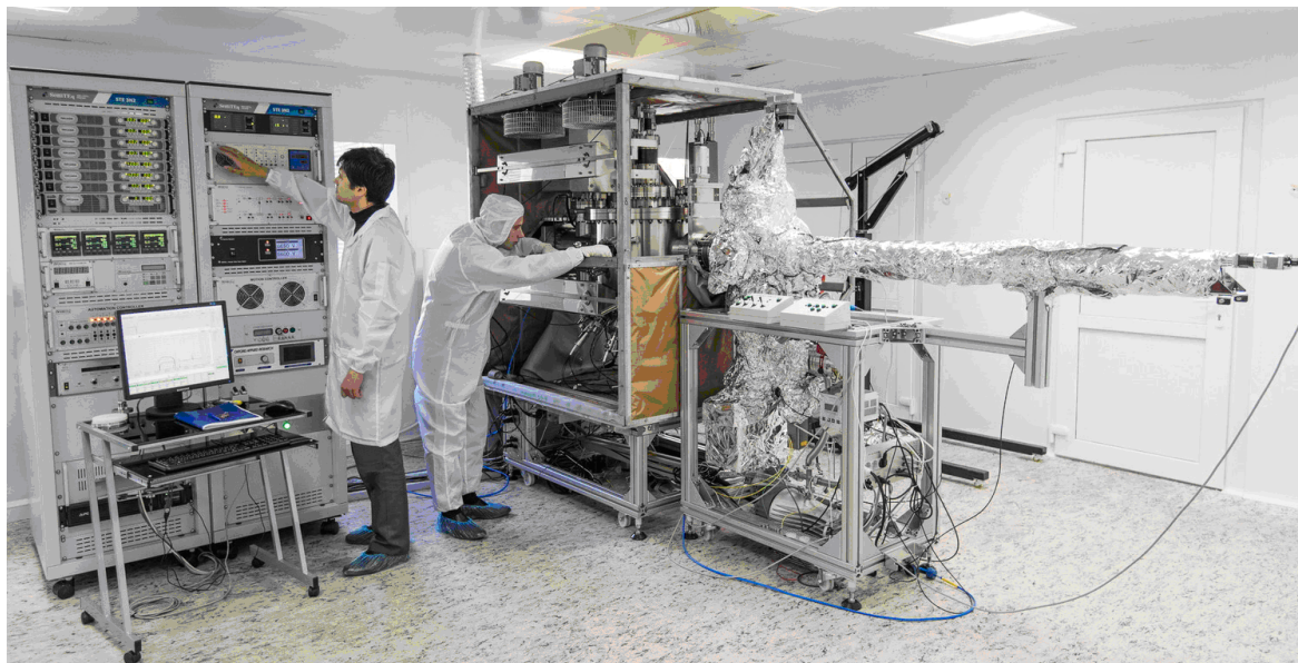
Рис. 1. Установка молекулярно лучевой эпитаксии SemiTeq STE3N2, установленная в Институте физики НАН Беларуси
